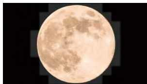
Local Dimming:部分制御で明るい場所のみ点灯
