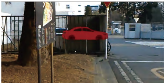
図1) HoloLensを掛けた歩行者から見た死角(この場合は壁)を通過する車両の表示例
