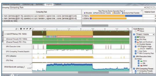
インテル VTuneプロファイラーによる、各スレッド、CPUとGPUの動作状況、メモリーアクセスのタイムラインを含む解析結果画面
