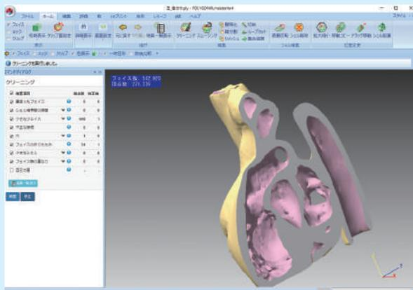
CT/MRIで撮像後ポリゴン化されたデータから必要部位の切り出し。滑らか、厚み付け、微細な浮遊データの除去が可能です。
